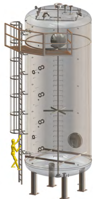
▲ Abbildung 1: Planungsansicht des 90-m 3 -FlüssigeisSpeichers.
