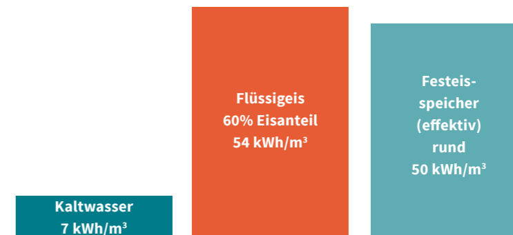
▲ Vergleich der volumetrischen Speicherkapazität verschiedener Kältespeicher
