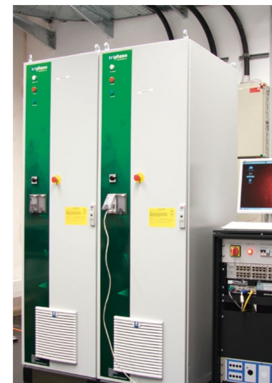
► Digitaler Echtzeit-Netzsimulator mit Umrichter vom TU-Berlin-Stromnetz zum Smart Grid Labor.
